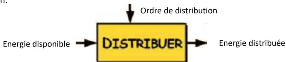
⇒ **Pour l'énergie électrique**, la fonction DISTRIBUER est assurée par un **contacteur** (si le courant est « important ») ou un relais (si le courant est « faible ») ; contacteur et relais sont des sortes « d'interrupteur ».
